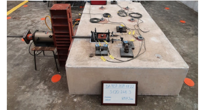
Şekil 3 • Disk başlıklı ankraj kesme deneyleri (Fotoğraf: Fatih Sütçü).
